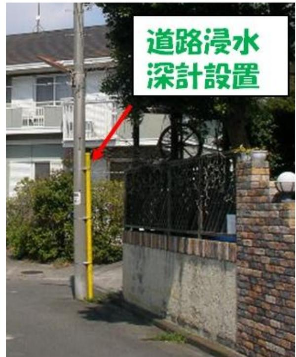
装置は筒型ケースに収められており、観測する道路の電柱や標識支柱などに取り付けることが出来ます。(保護管に収納します)
